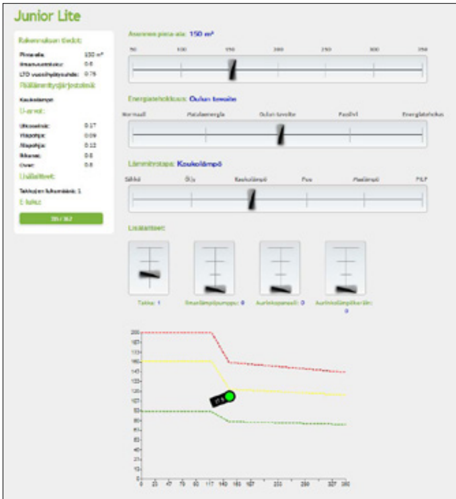
Kuva 3: Junior Lite –ohjelmalla ( https://www.energiajunior.fi/elukulaskuri ) voi iteroida energialaskentaa suunnitteluprosessin aikana. Liukukytkimillä valitaan rakennuksen koko ja –energiatohokkuus sekä lämmitysmuoto. Lisäksi valitaan tulisijojen määrä, ilmalämpöpumppu, aurinkokerääjien ja –paneelien pinta-ala. Ohjelma laskee alustavan E-luvun, jonka perusteella voidaan arvioida suunnitteluratkaisun energiatohokkuutta.
