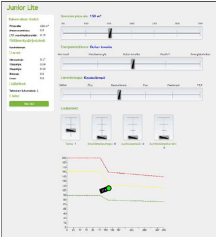
Kuva 3: Junior Lite –ohjelmalla ( https://www.energiajunior.fi/elukulaskuri ) voi iteroida energialaskentaa suunnitteluprosessin aikana. Liukukytkimillä valitaan rakennuksen koko ja –energiatohokkuus sekä lämmitysmuoto. Lisäksi valitaan tulisijojen määrä, ilmalämpöpumppu, aurinkokerääjien ja –paneelin pinta-ala. Ohjelma laskee alustavan E-luvun, jonka perusteella voidaan arvioida suunnitteluratkaisun energiatohokkuutta.
